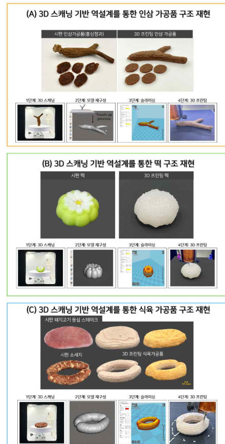
그림 4. 압출 기반 3D 식품프린팅을 이용한 식품의 구조 재현 및 디지털 제조 공정 개념도 (출처: Kim 등, 2026; Kim 등, 2025; Kim 등, 2024).
